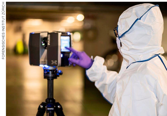
Laserscanning am Tatort: Soll Kamera und Messband ersetzen
